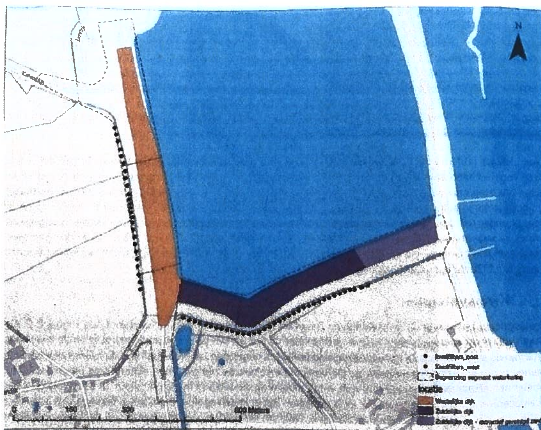
Figuur 3: Kwelfilters bij westelijke en zuidelijke dijk. Royal HaskoningDHV, 28 april 2022, p. 18.
